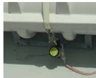
Устройство гидростатического выброса, прикрепленное к спасательному плоту
